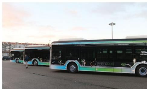
**Em dezembro de 2018, a CMA e a Transdev apresentaram três novos veículos 100 por cento elétricos da Aveirobus. Cada um dos autocarros tem capacidade para transportar mais de 60 pessoas e estão equipados com motores elétricos de 700V e potência máxima de 160Kw.**
