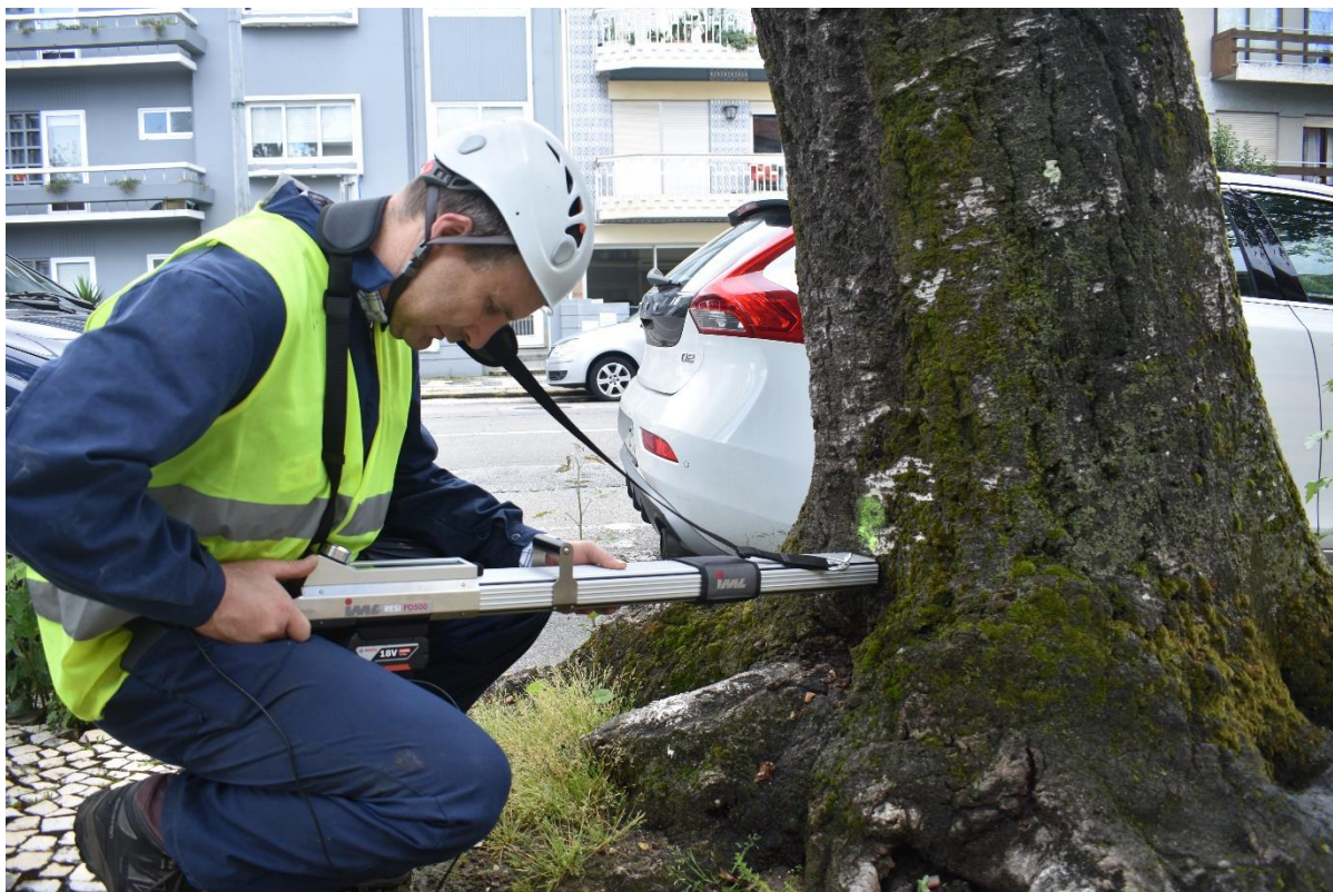
Figura 5.17 – Medição com Resistógrafo do choupo nº 22 na zona do colo da árvore.
